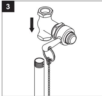
Asegúrese de que la tubería de suministro de agua (1/2 "galvanizado se recomienda, pero no incluidas) es un buen apoyo y una válvula de rosca en el tubo de alimentación. Asegúrese de que la válvula esté apuntando hacia abajo (de la cadena tira hacia abajo).
