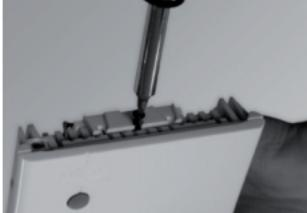
4. Luego retire la base de montaje en la parte posterior del termostato inclinando hacia abajo y luego hágala usted.
