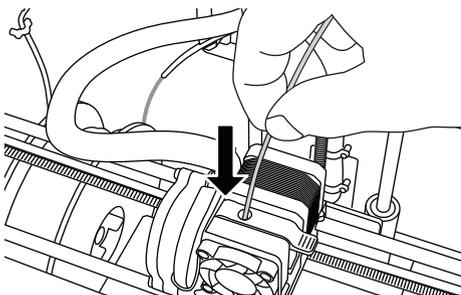
**⚠ ADVERTENCIA** No toque la punta del extrusor durante el funcionamiento de la Dremel 3D20 o hasta que se haya enfriado por lo menos hasta 60 °C (140 °F). El contacto con la punta del extrusor durante el funcionamiento o después de éste, antes de que la punta se haya enfriado, podría causar lesiones corporales.
