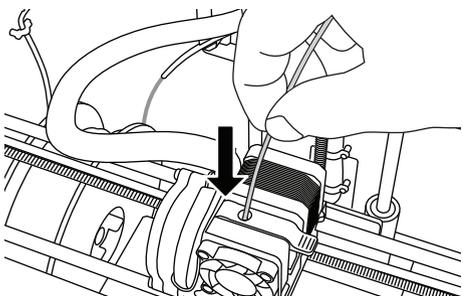
**⚠ AVERTISSEMENT** ne touchez pas la pointe de l'extrudeuse pendant le fonctionnement de votre équipement Dremel 3D20 ou avant qu'il ne se soit refroidi jusqu'à au moins 60° C (140° F). Un contact avec la pointe de l'extrudeuse pendant le fonctionnement ou après l'interruption du fonctionnement mais avant qu'elle ait suffisamment refroidi pourrait causer des blessures.
