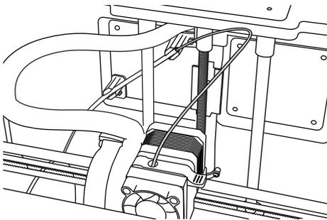
11. La Dremel 3D20 comenzará a calentar el extrusor. La visualización de la pantalla táctil de la Dremel 3D20 le avisará cuando el extrusor esté "CALIENTE" y listo para cargar.
