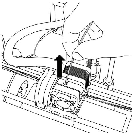
**NOTA:** Es posible que quede una pequeña cantidad de filamento en el extrusor. Puede que el comienzo de su siguiente objeto tenga algo de color de este filamento hasta que haga la transición al color de su filamento. Deje que el filamento de repuesto extruda completamente antes de comenzar el próximo objeto, para asegurar un color uniforme.
