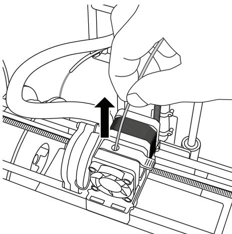
**REMARQUE** : une faible longueur de filament restera peut-être à l'intérieur de l'extrudeuse. le début de votre prochain objet pourra incorporer un peu de cette couleur de filament jusqu'à la transition à la couleur du filament que vous aurez choisie. Laissez le filament de remplacement s'extruder complètement avant de commencer à construire votre nouvel objet afin d'assurer une couleur uniforme.
