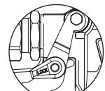
Coloque el seguro del gatillo en la posición de bloqueo
