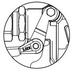
12. Verrouiller le pistolet en mettant le verrou de détente à la position appropriée.
