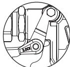
Coloque el seguro del gatillo en la posición de bloqueo
