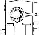
9. Soulever la soupape PRIME/SPRAY à la position SPRAY.
