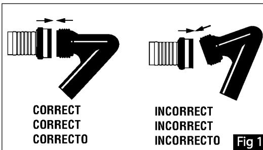
**Brancher le tuyau d'arrosage du jardin.** Si le tuyau possède un manchon rigide, glissez le manchon du tuyau jusqu'à l'autre extrémité du tuyau.
